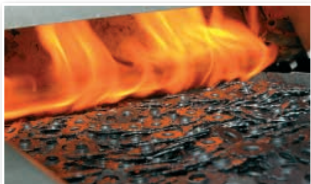
Temple/revenido en hornos continuos automáticos en una atmósfera protectora
