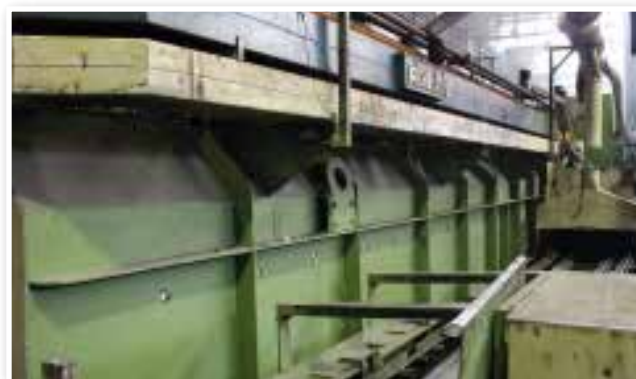
Temple/revenido en hornos continuos automáticos en una atmósfera protectora
